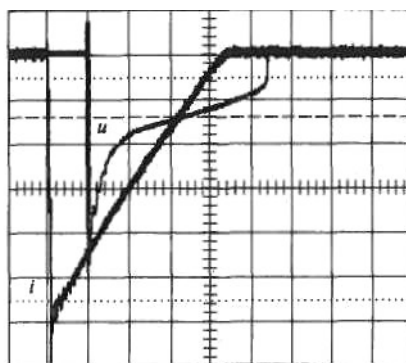
Рис. 6.43. Осциллограммы тока i и напряжения u : m_i=3,7 кА/дел.; m_u=800 В/дел.; m_t=200 мкс/дел.
