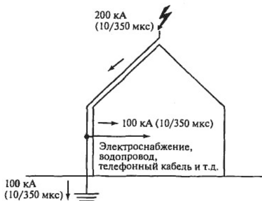
Рис. 5.41. Распределение тока молнии
