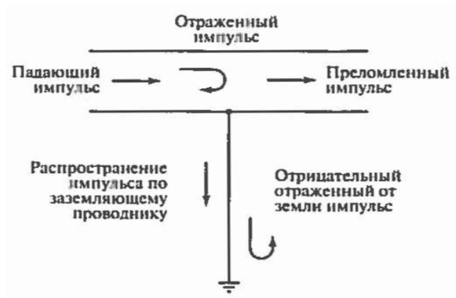
Рис. 10.33. Распространение импульса по заземляющему проводнику
